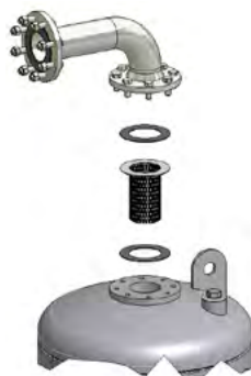
Demontáž prachového sitka
